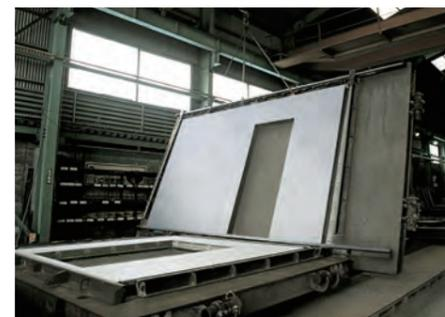
促進養生を終えたコンクリートパネルを型枠から取り外します。
